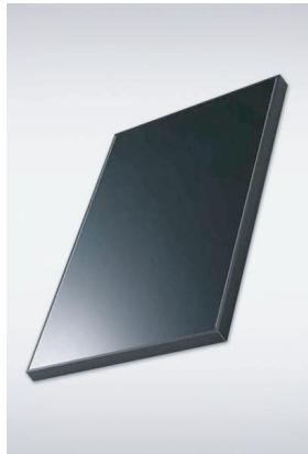
国内一貫生産で高い品質を誇るソーラーフロンティア社製CISモジュールを採用しました。従来の結晶シリコン系太陽電池に比べて、CIS太陽電池は高温時の出力ロスが少なく、部分的な影の影響も少なく、太陽光に当たると出力が上がるという性質をもっているので、実質的な発電量で結果を出すことができます。さらに長期出力保証20年付帯で安心です。
